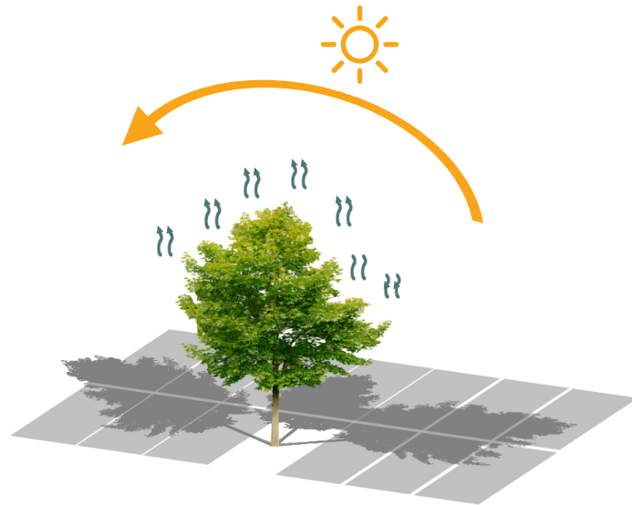
Schatten- und Kühlwirkung eines Baumes auf die Parkplatz- und Abstellflächen im Tagesverlauf.
